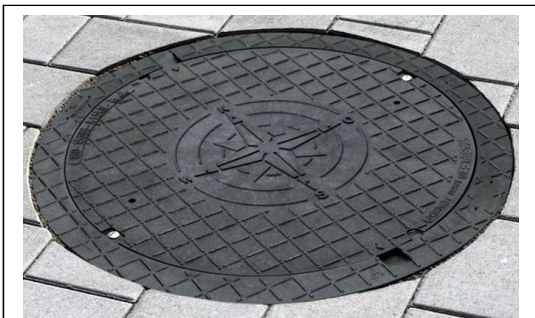
Swiss-Edition DN 600 mit CH-Modulrahmen, mit Deckel Design Windrose ohne Griffmulden - Ansicht von oben - neu mit Belastungsklasse A35kN
